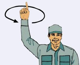
**Levante el equipo.** Señale hacia arriba con el dedo índice mientras hace un círculo a la altura de la cabeza.
