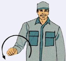
**Encienda el motor.** Mueva el brazo circularmente al nivel de la cintura como si estuviera arrancando el motor.
