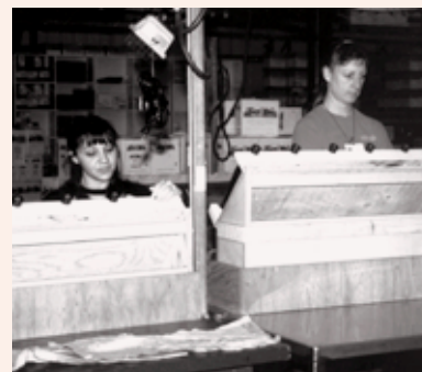
La adición o remoción de una plataforma permite que la altura de la superficie de trabajo sea ajustable para acomodar cada empleado.
