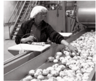
Alcances extendidos por encima de una transportadora ancha
