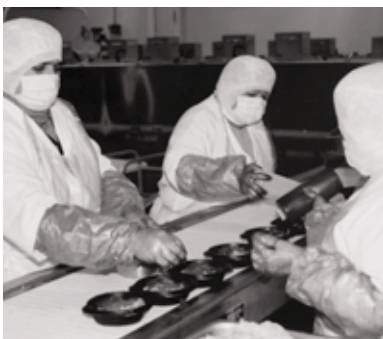
Exprimir un dispensador de producto alimenticio líquido a mano requiere agarre repetitivo de gran esfuerzo físico.
