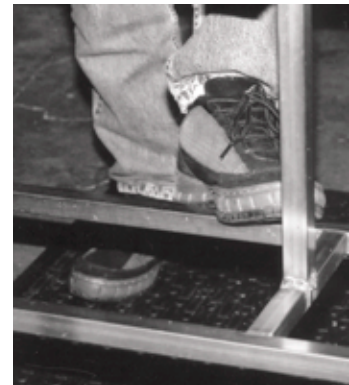
Para empleados que permanecen de pie mucho tiempo, el riel reposapiés reduce la tensión muscular en la parte baja de la espalda.
