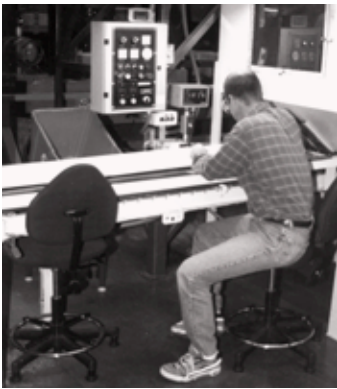
Los paneles de control están muy lejos del trabajador
