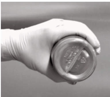
Un pomo puede causar fatiga si el diámetro es mayor de 2 pulgadas.
