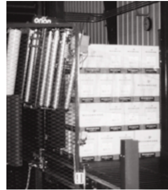
El uso de equipo automático para aplicar plástico encogible, elimina la necesidad que el trabajador adopte posturas que causan tensión muscular.
