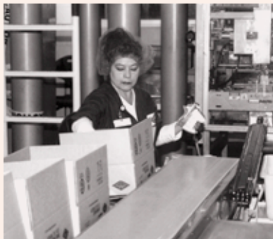
Una superficie de trabajo demasiado alta puede causar una postura que provoque tensión muscular en el hombro.
