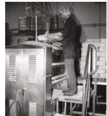
Una superficie de trabajo mas elevada permite que el empleado trabaje en postura mas erguida.
