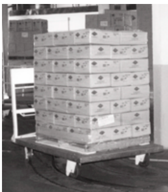
Esta carretilla "pallet" corre sobre vías automáticas en la planta.
