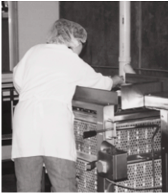
Una superficie de trabajo demasiado ancha para el trabajador requiere un alcance extendido.
