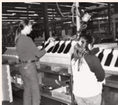
La adición o remoción de una plataforma permite que la altura de la superficie de trabajo sea ajustable para acomodar cada empleado.
