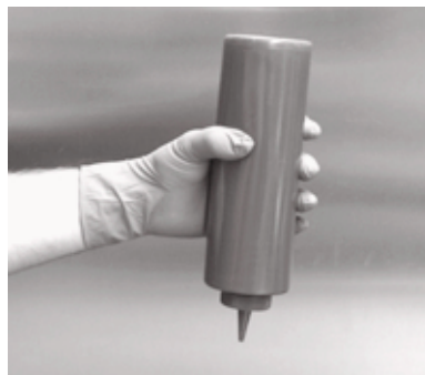
Un pomo puede causar fatiga si el diámetro es mayor de 2 pulgadas.
