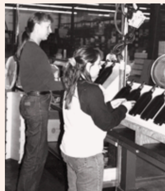
Puestos de trabajo ajustables permiten que los empleados trabajen en una postura cómoda y neutral.
