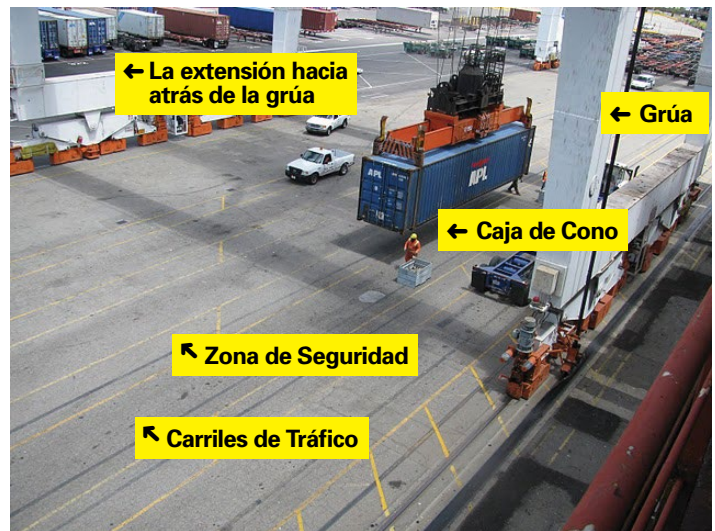
Rayas para carriles de tráfico y zonas de seguridad personal bajo la grúa.
